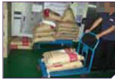
크레인, 대차를 이용한 원료의 호퍼 내 투입
